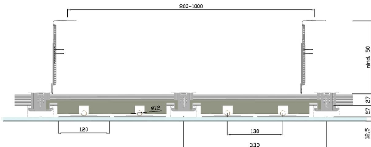
Unterkonstruktion nach DIN 18182/1
