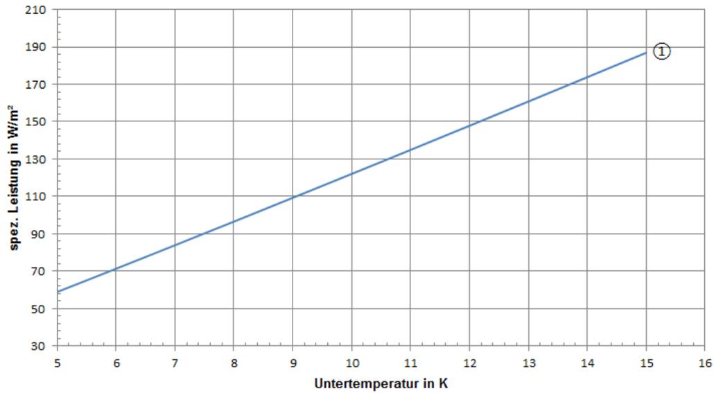
Kühlleistung nach DIN EN 14240: **122 W/m² bei 10 K**
