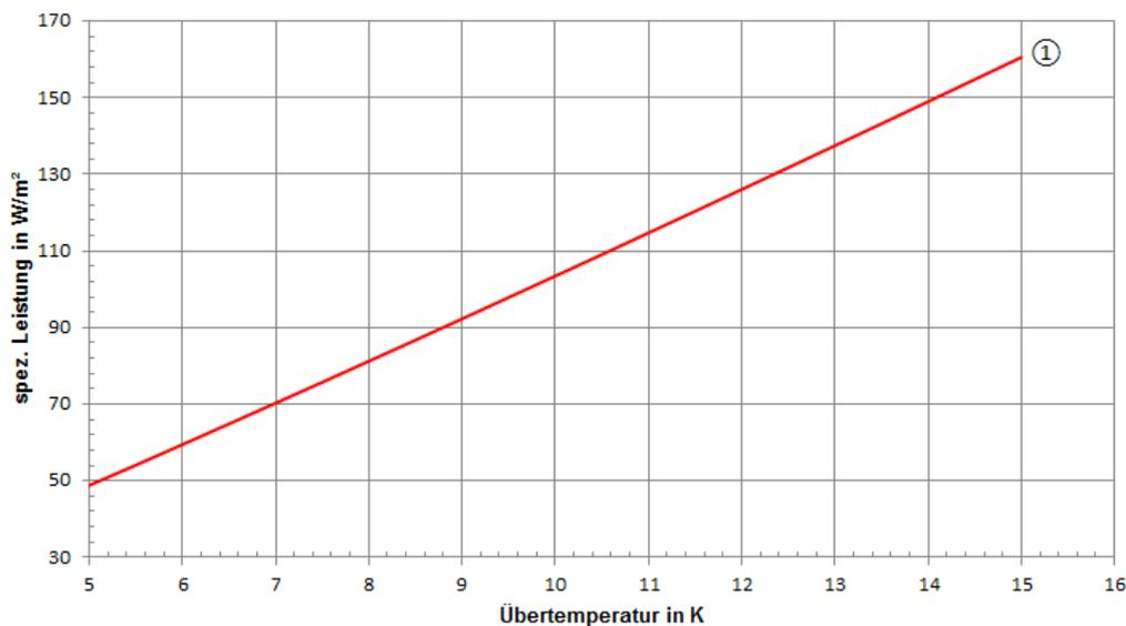
Heizleistung nach DIN EN 14307: **160 W/m² bei 15 K**
